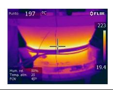
Existe una tecnología denominada "inducción electromagnética" la cual utiliza equipos electrónicos modernos para calentar el acero de una manera muy rápida, controlada y eficiente energéticamente. El calor se genera dentro de la misma pieza, en el lugar execto que se protondo calentar y e la temperatura
